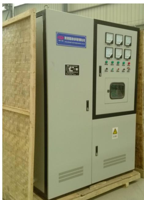
c. “完全封闭”的箱体设计，在确保内部空气充分流通的情况下（散热通风窗均设置过滤）提高了内部环境的清洁。有利地克服了导电性尘埃引起的绝缘失效。对潮湿的环境下使用的电源，其内部配置了电加热器，防止流通空气的湿度大而对端子或接线柱形成腐蚀。
